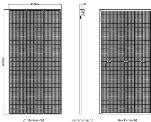
\* Die nicht gekennzeichnete Toleranz beträgt ±1 mm Länge in mm angegeben
